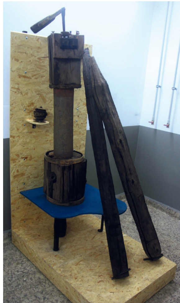
Abb. 2 Grube Gottessegen. Pumpe und Rohre aus dem Bensbergs Gesenk auf der Präsentationsinstallation des Wasserverbandes Siegen-Wittgenstein (Foto: LWL-Archäologie für Westfalen/M. Zeiler).
