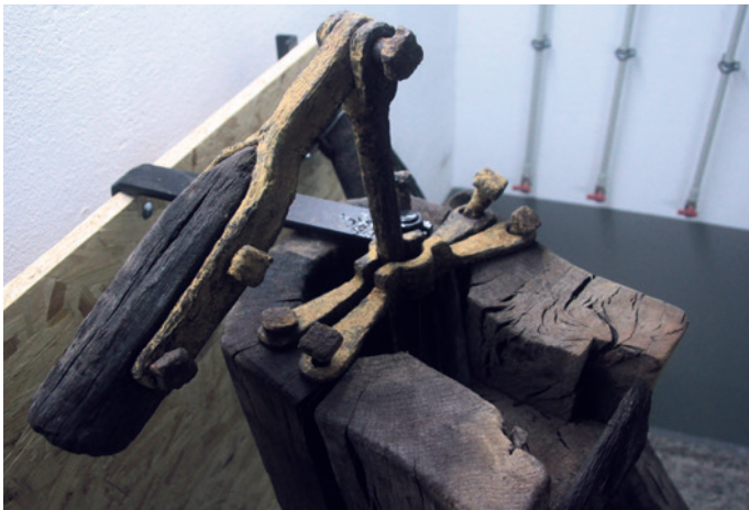
Abb. 10 Grube Gottesesegen. Kolbenstangenführung der Pumpe aus dem Bensbergs Gesenk (Foto: LWL-Archäologie für Westfalen/M. Zeiler).
