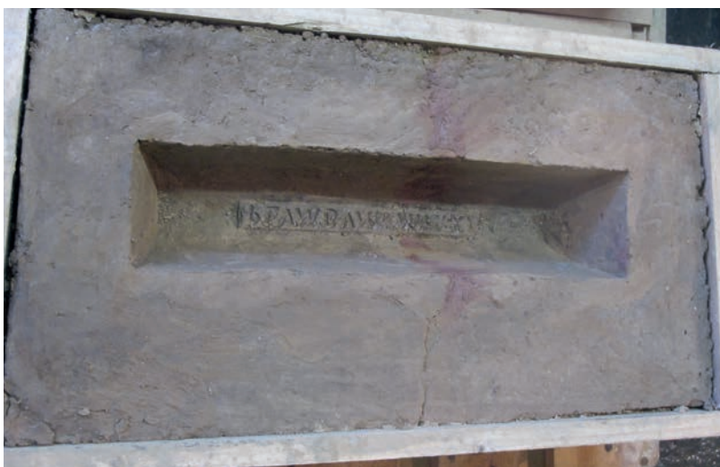
Abb. 2 Lehmsandform mit Holzverschalung; in der Mitte sind deutlich Risse mit nachträglichen Reparaturen in der Gussform erkennbar (Foto: N. Hanel).
