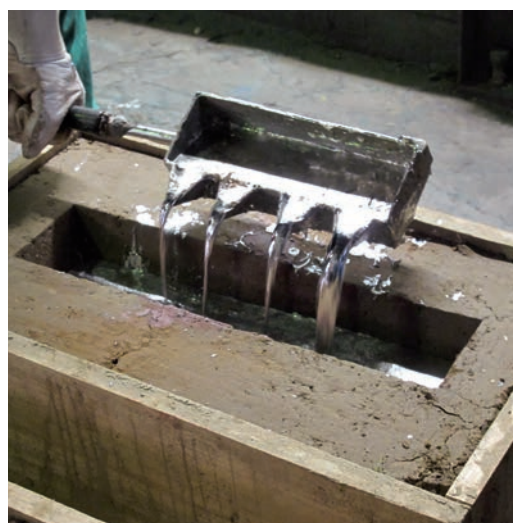
Abb. 2 Lehmsandform mit Holzverschalung; in der Mitte sind deutlich Risse mit nachträglichen Reparaturen in der Gussform erkennbar (Foto: N. Hanel).
