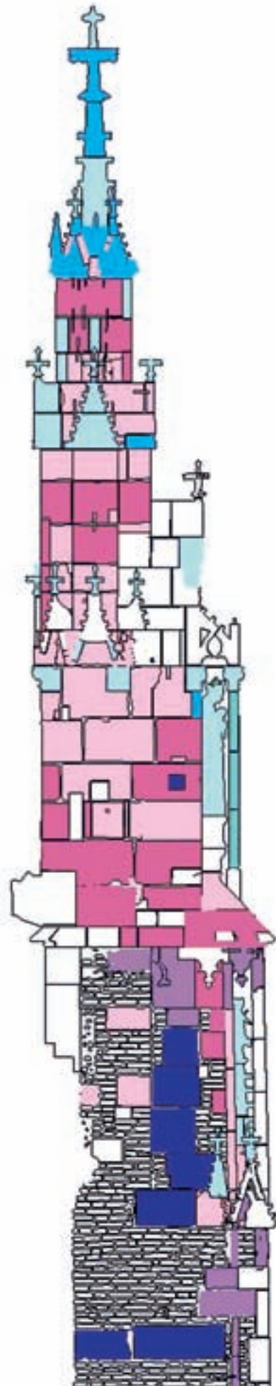
2 Kataster der Stein- sorten mit Legende, Ulmer Münster, Südlicher Chorturm, Marienpfeiler, Ansicht der Westseite.
