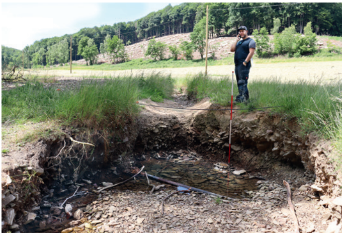
Abb. 15 Trichterbildung und Ausspülung eines temporären Seitenarmes des Holthäuser Baches in Hagen (Foto: LWL-Archäologie für Westfalen/F. Gumboldt).
