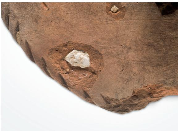
Abb. 3 Zieglerdeckel Z 136 mit großen Kalkeinschlüssen, die zu Abplatzungen führten, Detail. O. M. (Foto: LWL-Archäologie für Westfalen/S. Brentführer).
