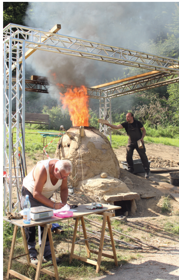
Abb. 20 Archäologisches Experiment 2017 mit dem Nachbau eines eisenzeitlichen Siegerländer Rennofens im LWL-Freilichtmuseum Hagen (Foto: LWL-Archäologie für Westfalen/M. Zeiler. CC BY-SA).
