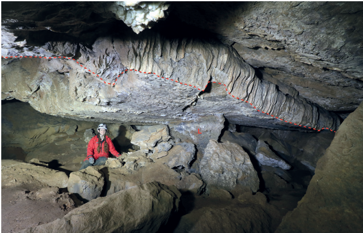
Abb. 56 Bergbau-Karst-Komplex Bärenhöhle im Felsenmeer bei Hemer (Liste 2, 58). Blick in eine ausgeräumte Schlotte. Eine Sinterdecke bricht unten dort ab (gestrichelte Linie), wo ehemals die Oberkante der Lehm-Erz-Einfüllung war. Die Bergleute ließen eine Bergfeste aus Lehm (L) zurück (Foto: LWL-Archäologie für Westfalen/T. Poggel. CC BY-SA).
