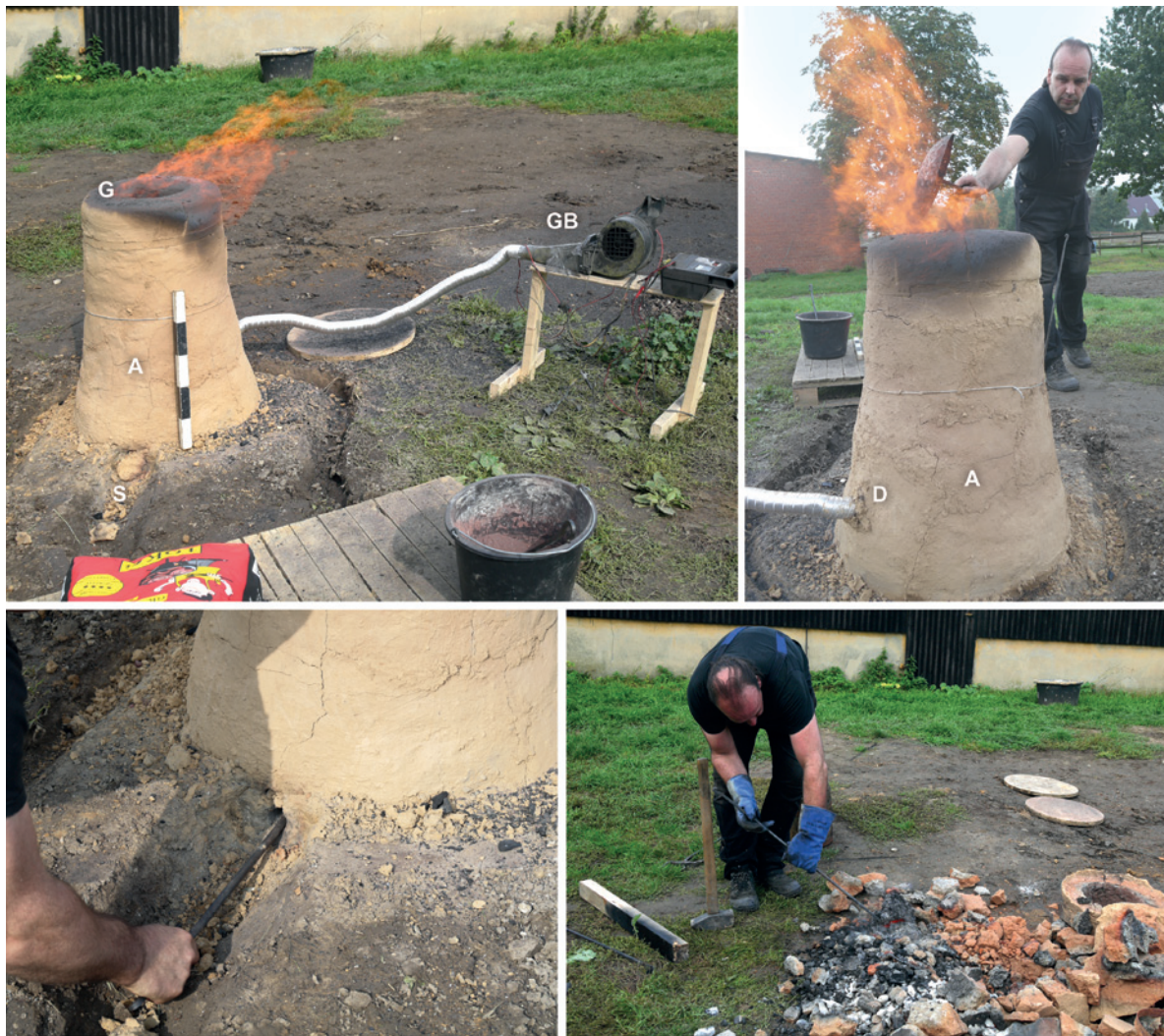
Abb. 30 Verhüttung in einem nachgebauten schachtförmigen Rennofen ohne Schlackengrube. Oben: Verhüttung; unten links: Abstichbeginn; unten rechts: Aufbrechen des Ofens; A: Rennofen; G: Gichtöffnung; GB: Gebläse; D: Düsenloch; S: Grube für den Schlackenabstich (Fotos: LWL-Archäologie für Westfalen/M. Zeiler. CC BY-SA).
