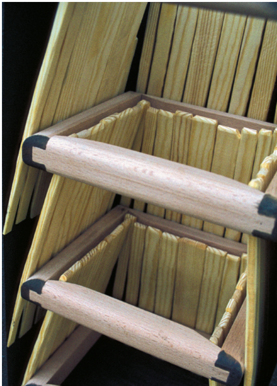
Abb. 64 Modell des Deutschen Bergbau-Museums Bochum, das die Verzimmerung von Schacht 2 auf dem Altenberg bei Müsen (Liste 2, 34) darstellt. Der Ausbau wurde vollständig verzapft bzw. geklemmt, ohne Nägel zu verwenden (Foto: Deutsches Bergbau-Museum Bochum).
