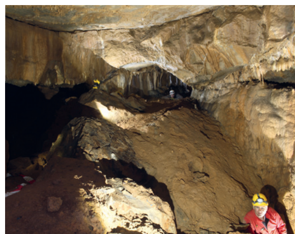
Abb. 54 Bergbau-Karst-Komplex Zwergenhallen im Felsenmeer bei Hemer (Liste 2, 58). Ausgeerzte und versetzte Lehmhalde zwischen den beiden Speläologen. Wenig darüber findet sich die durchbrochene Sinterdecke in der Firste (Foto: LWL-Archäologie für Westfalen/M. Zeiler. CC BY-SA).
