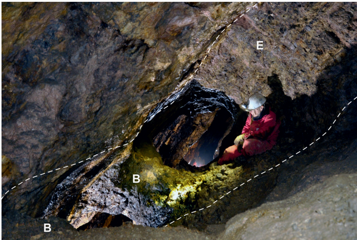
Abb. 2 Beispiel für ein Gangerzvorkommen: Grube Jungfer bei Hilchenbach-Müsen. Blick nach Nordosten in eine teil-ausgeerzte Gangstruktur (zwischen den gestrichelten Linien), die schräg gestellt im Schiefer liegt. Zur Oberfläche hin wurde der Erzgang als nicht abbauwürdig befunden und stehen gelassen (E), während in den abgebauten Gangpartien Bergfesten zur Sicherung (B) belassen wurden (Foto: Deutsches Bergbau-Museum Bochum/G. Steffens).
