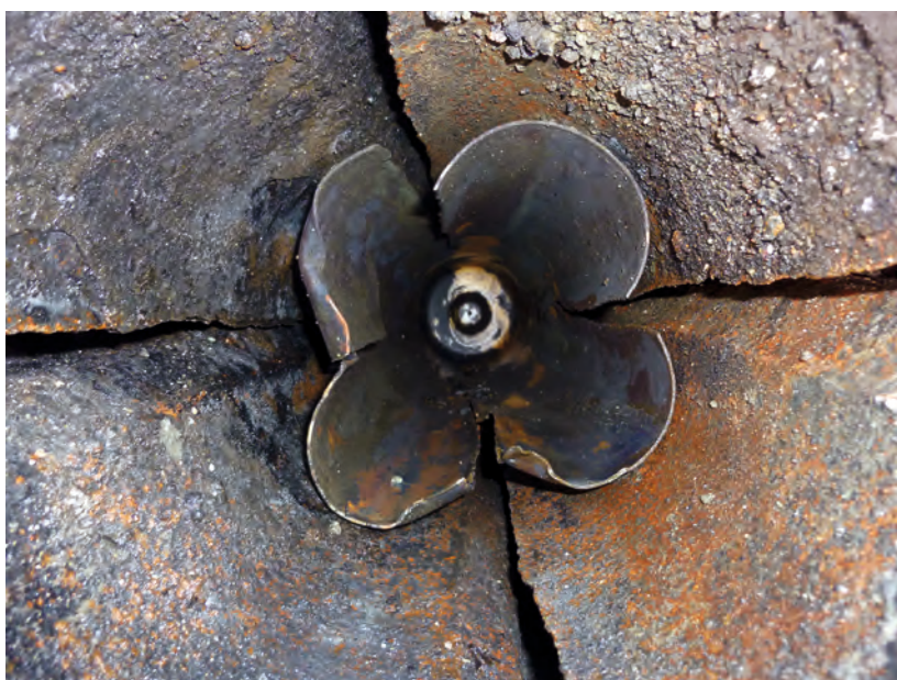
2 Essen-Stadtkern. Blick in den zerborstenen Lauf des Geschützes mit Resten der explodierten Hülse.
