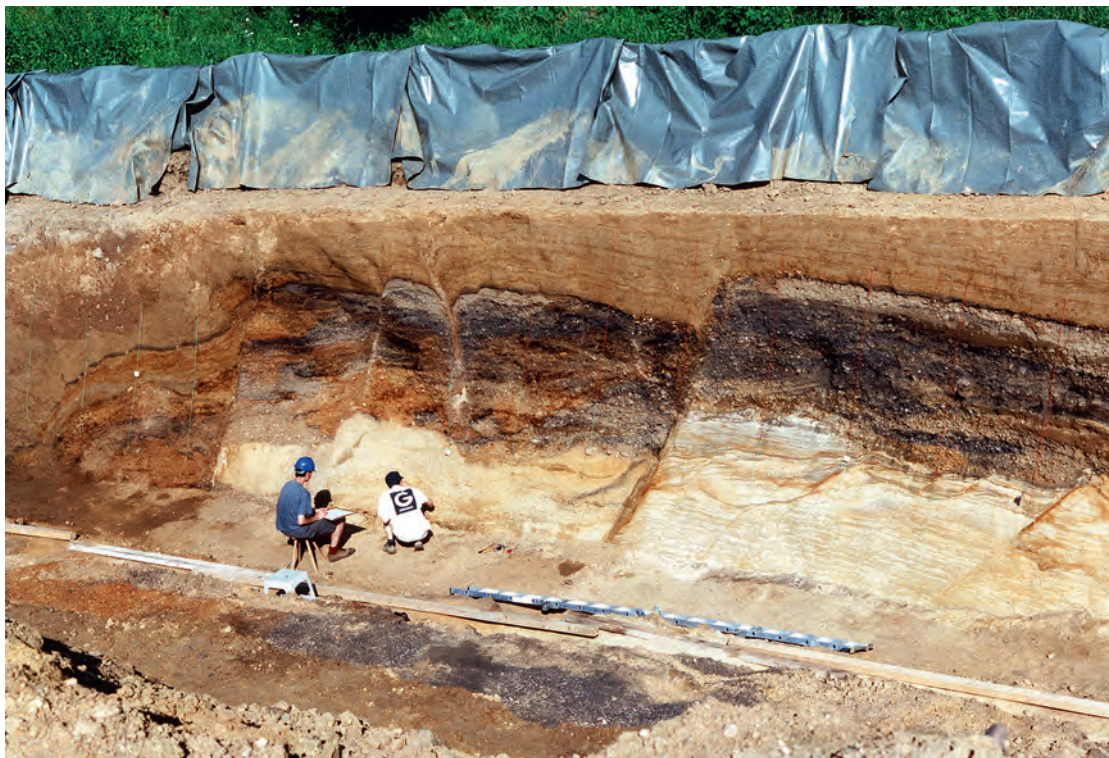
3 Jülich-Stallbusch. Nordwestwand des Paläoseismikschurfes am Rurrand. Ein Teil der Schichtversätze gibt Hinweise auf frühere Starkbeben.
