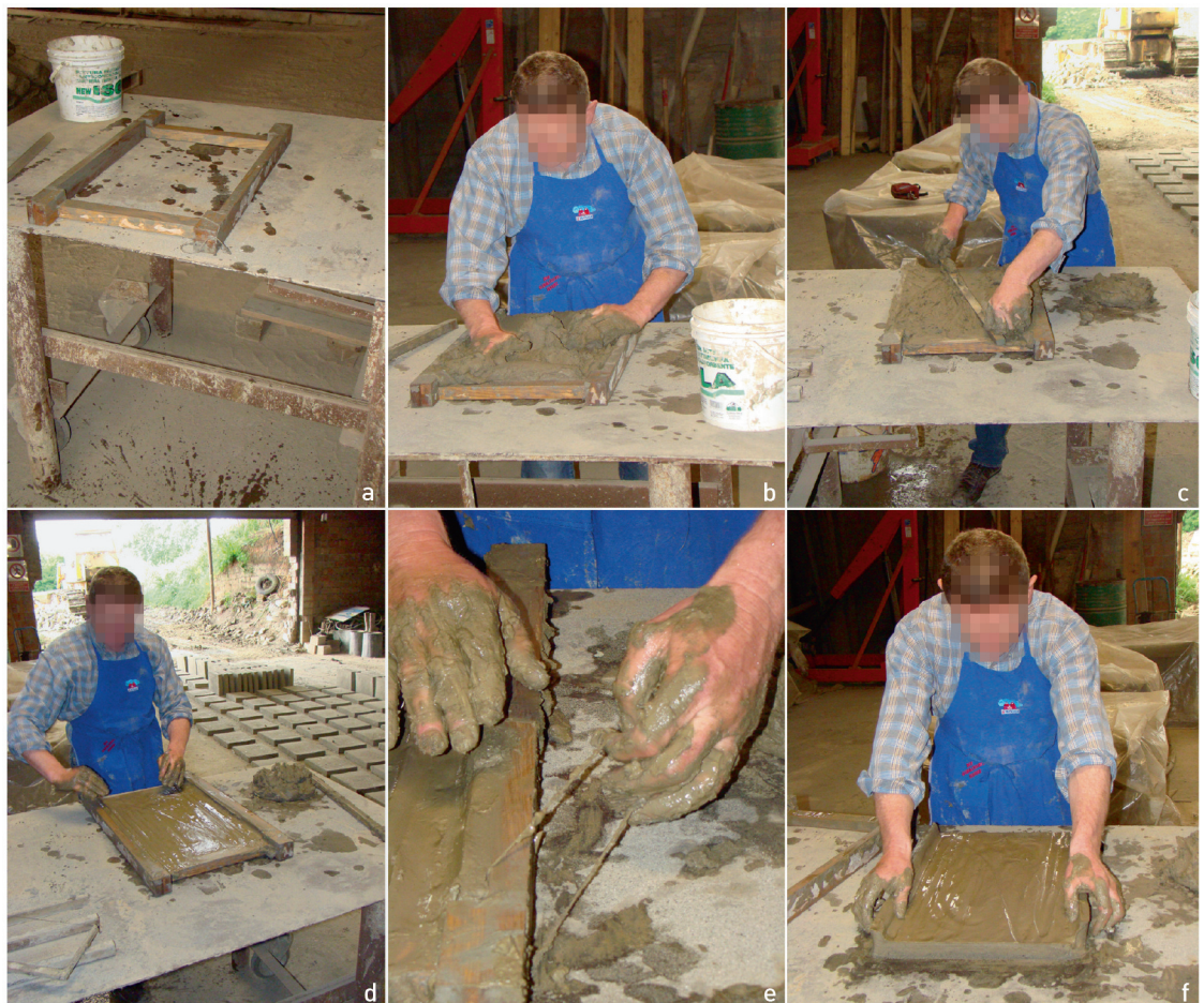
1 Herstellung von tegulae (Dachziegel): a Holzrahmen zur Herstellung einer tegula ; b Einschlagen des Tons in den Holzrahmen; c Einstreichen des Tons in die Ecken und Abziehen mit einer Holzleiste; d Glätten der Oberfläche mit Wasser; e Trennen des Rohlings vom Holzrahmen mit einer Schnurschleife; f Überarbeiten des Rohlings nach Abnahme des Holzrahmens.
