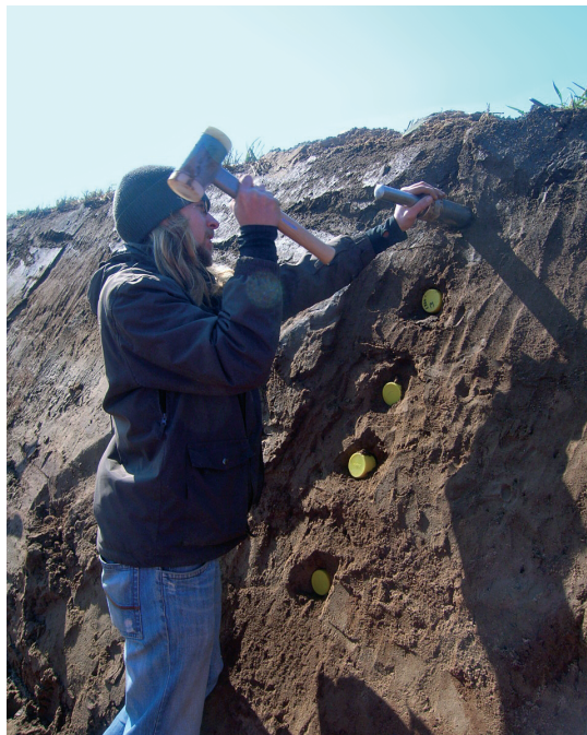
3 Weeze-Vorselaar. Probennahme für OSL- Messungen in lichtdich- ten Stahlzylindern.
