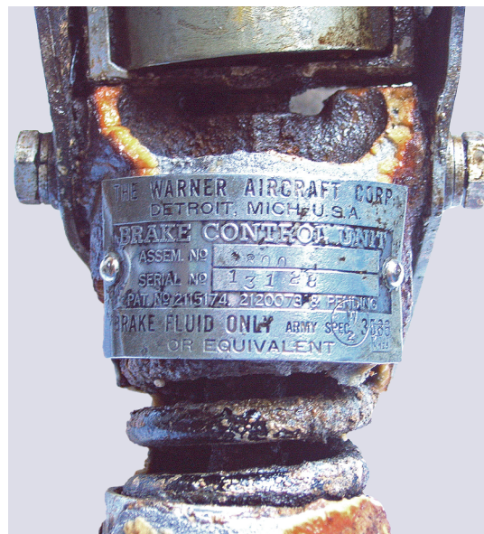
1 Ratingen. Typenschild auf einem Bremszylinder einer 1944 abgeschossenen P-47 Thunderbolt.
