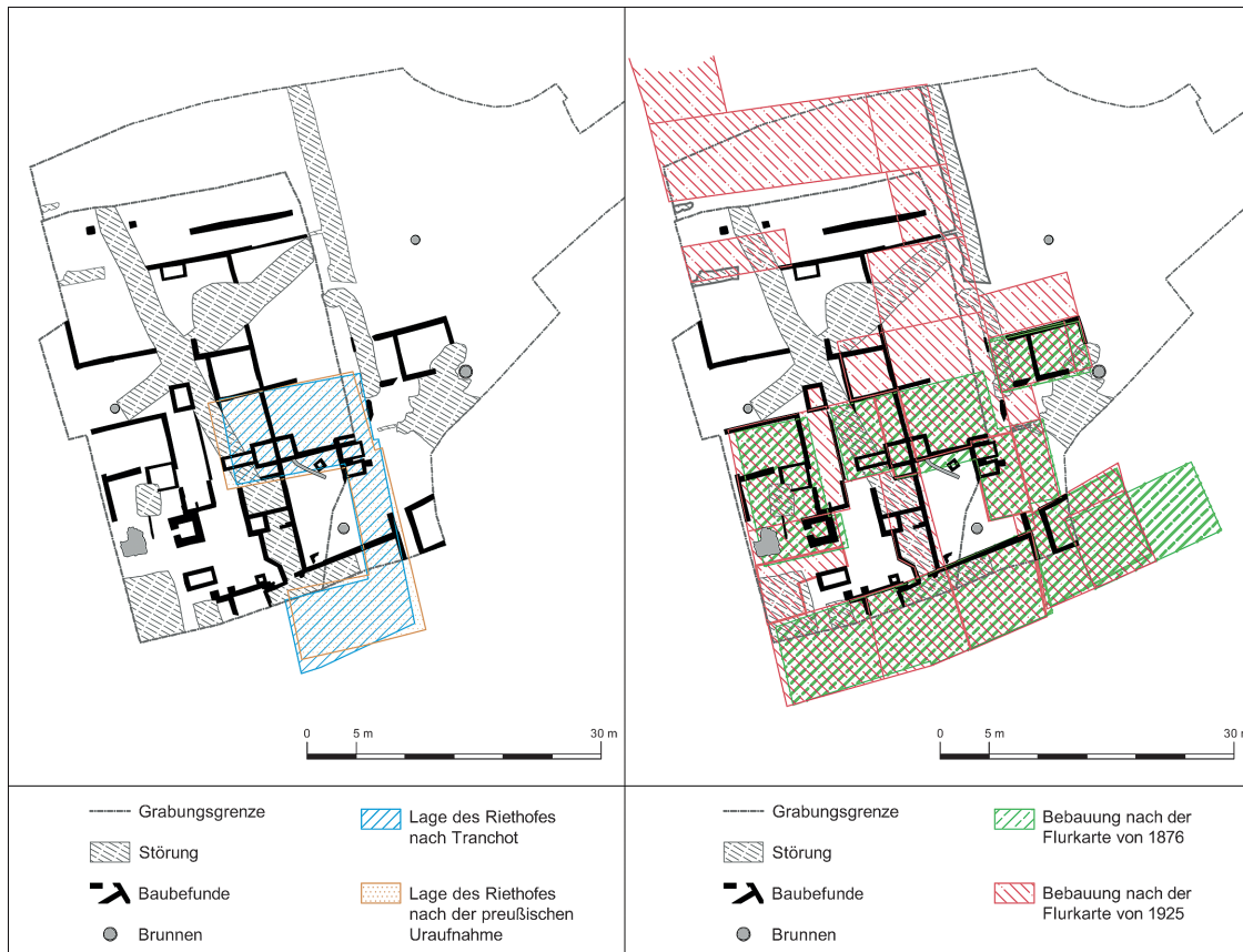
167 Viersen-Rintgen. Baubefunde der Grabung mit Überblendung der Kartenwerke des 19. und 20. Jahrhunderts.
