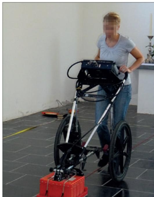
**3** Linnich-Körrenzig. Alte Pfarrkirche St. Peter. Oben: Das Georadar im Einsatz; unten: Der rote Strich markiert einen links daneben hervortretenden Fundamentzug zwischen den Mitteljochen von Mittel- und Südschiff, der Bauphase 1 zugeordnet wird (Bild 0,80 m Tiefe).
