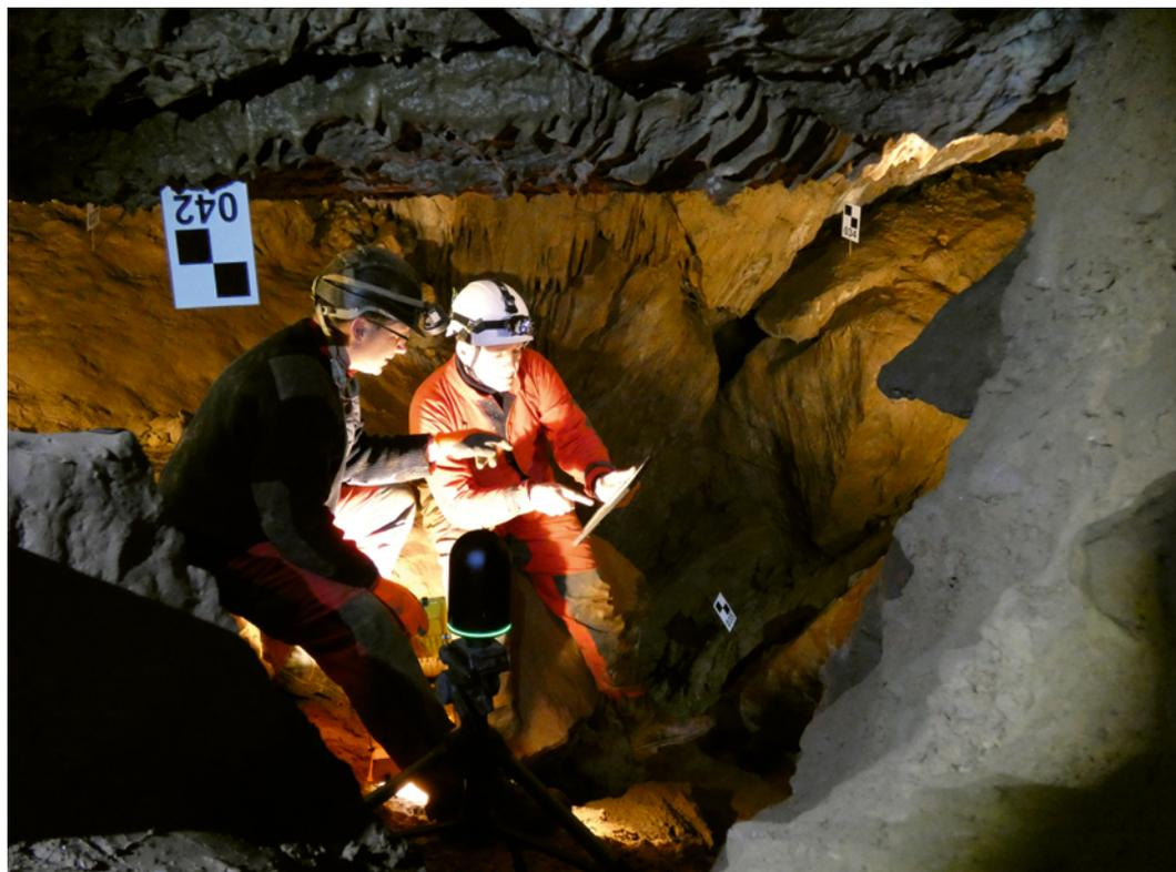
**Abb. 1** 3-D-Dokumentation durch die Speläogruppe Sauerland e.V.: Damit der Scan auch kleine Hohlräume oder komplexe Kluftzonen erfasst, muss der Scanner (Bildvordergrund) vielfach umgestellt werden. Die Scans werden über mitgescannte Passpunkte (Täfelchen mit schwarzen Quadraten) zu einer Datei zusammengefügt (Foto: Speläogruppe Sauerland e.V./W. Hänisch).
