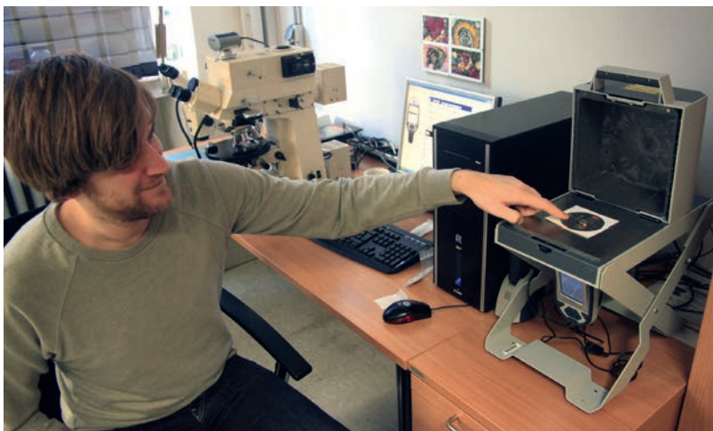
Abb. 3 RFA-Messung einer Münze im Labor des Deutschen Bergbau-Museums Bochum (Foto: LWL-Archäologie für Westfalen/M. Zeiler).
