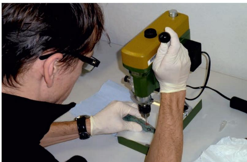
Abb. 3 Metallurgische Probenentnahme mittels einer kleinen Bohrmaschine, mit der feine Späne aus der Kupferbeilklinge herausgebohrt wurden (Foto: LWL-Archäologie für Westfalen/M. Baales).
