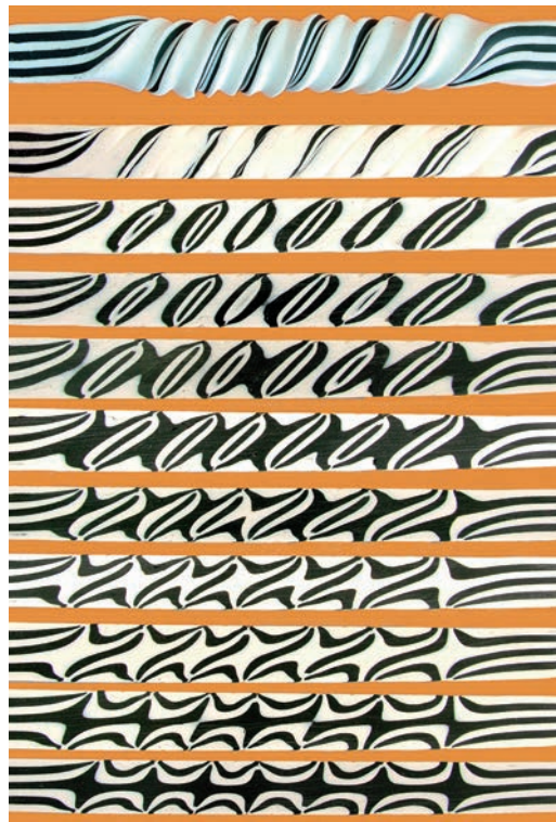
Abb. 1 Musteränderungen beim Anschleifen eines siebenlagigen Torsionsdamaststabes aus Fimoplast. Oben: Der tordierte Stab, darunter der zu einem Vierkant »umgeschmiedete« Stab. Die Musteränderungen werden beim schichtweisen Abschleifen bis zur Stabmitte sichtbar (Foto: LWL-Archäologie für Westfalen/E. Müsch).
