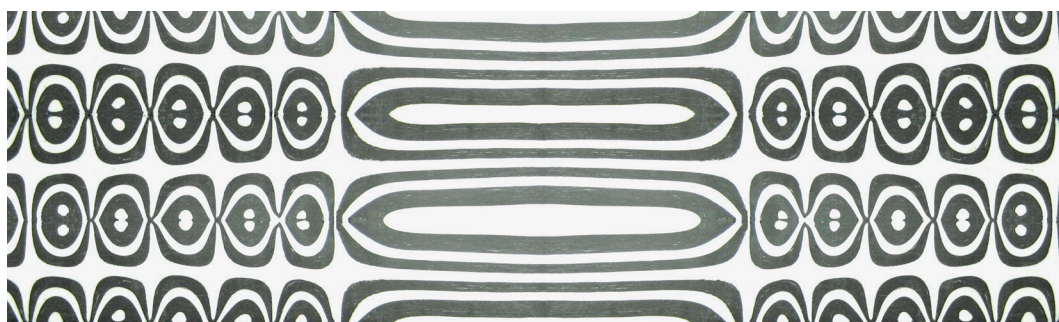
Abb. 4 Schema des Oberflächenklingemusters der Vorderseite der Spatha aus dem Fürstengrab von Beckum aus Fimo. Weitere Arbeitsschritte haben das ursprüngliche Musterbild des Rosendamastes verändert (vergl. Abb. 3). Weiß steht für die Eisen- oder niedriger legierten Stahllagen, Schwarz für höher legierte Stahllagen (Foto: LWL-Archäologie für Westfalen/E. MÜsch).
