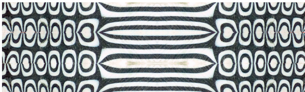
Abb. 3 Musterbild aus der Stabmitte von drei SZS-tordierten Stäben, kombiniert zum sogenannten Rosen- oder Rosetendamast im Wechsel mit Streifendamast (Foto: LWL-Archäologie für Westfalen/E. MÜsch).
