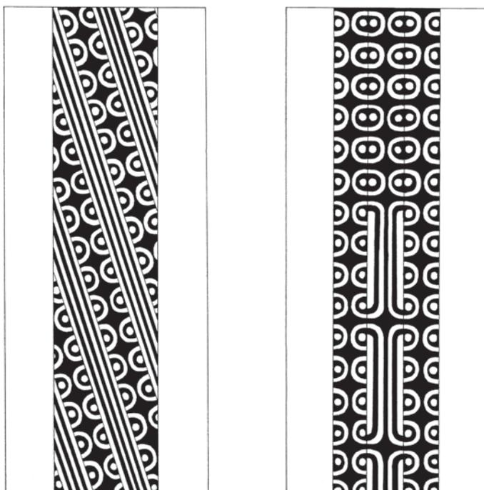
kel leicht schräggestellt (Abb. 3). Dabei wechseln sich verdrehte und nicht verdrehte Kompositstäbe stets ab. Wiederum wurde die Materialstärke der einzelnen Bestandteile auf die Hälfte reduziert, sodass sich eine Oberflächenzeichnung aus sich abwechselnden sparsamartig angeordneten Bahnen von parallelen Streifen und halbkreisartigen Strukturen ergibt.
