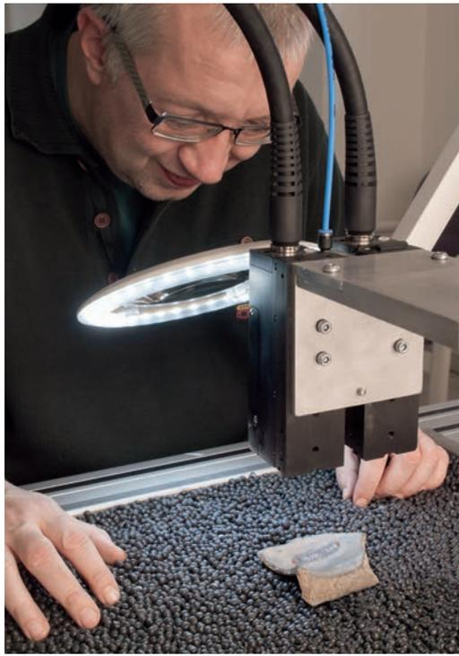
**Abb. 4** Mithilfe eines Spezialgranulats wird der zu beschriftende Fund zwischen den Lichtpunkten der Laserpointer positioniert (Foto: LWL-Archäologie für Westfalen/S. Brentführer).
