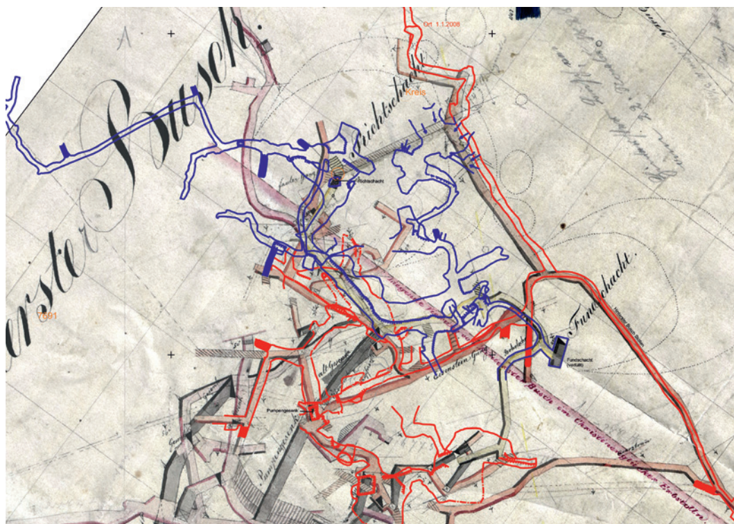
Abb. 4 Grubenbild mit überlagerter Neuvermessung (Grafik: Deutsches Bergbau-Museum Bochum/G. Steffens; Grundlage: Bezirksregierung Arnsberg, Abteilung Bergbau und Energie in NRW/H. Busch, S. Mengede).
