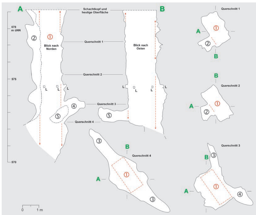
Abb. 3 Riss und Schnitte des Rosina-Schachtes. A: Saigerriss; B: Längsschnitt; 1: Schachtkörper (rote gestrichelte Linie: rekonstruierter Schachtkörper); 2: Tauber Erzgang (= Abb. 2 K); 3: Ausgeerzter Gang; 4–5: Suchorte; L: Bühnenloch (Grafik: Deutsches Bergbau-Museum Bochum/ F. Klein, G. Steffens und LWL-Archäologie für Westfalen/M. Zeiler).
