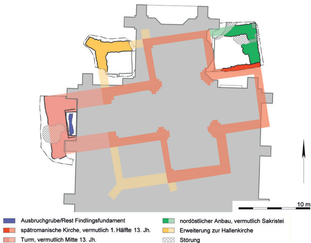
Abb. 2 Die Ochtruper Lambertikirche vor 1866, Befunde von 2016 mit der Rekonstruktion der Bauphasen nach Bild- und Textzeugnissen und der Projektion des Kirchenneubaus von 1866/1870 (Grafik: Denkmal3D, Vechta, und LWL-Archäologie für Westfalen/M. Thede).
