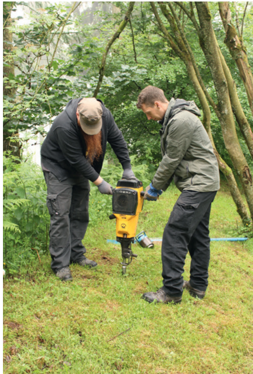
Abb. 2 Rammkernbohrungen auf der Wallburg Kindelsberg (Foto: LWL-Archäologie für Westfalen/M. Zeiler).
