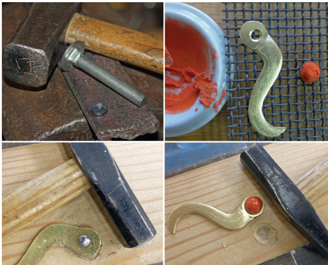
Abb. 5 Rekonstruktion und experimentelle Archäologie zum Vernieten von Ziernieten mit Glaseinlagen. Oben links: Schmieden des Nietes aus Eisen; oben rechts: Einbringen von Glaspulver (Email) in den Nietkopf; unten links: Vernieten mit einer Kettenpanzerschließe aus Messing von der Rückseite her; unten rechts: Endergebnis (Vorderseite) (Fotos: LWL-Archäologie für Westfalen/E. Müsch).
