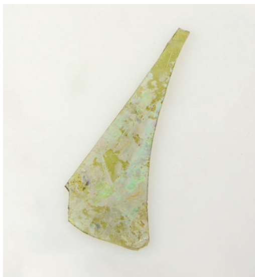
Abb. 1 In der Restaurierungswerkstatt der Zentralen Dienste der LWL-Archäologie für Westfalen wurden die intakten Korrosionslamellen (irisierende Schichten über dem grünen Grundglas) vor dem Überzug dokumentiert, M 1:1 (Foto: Fachhochschule Erfurt/L.-K. Renker).
