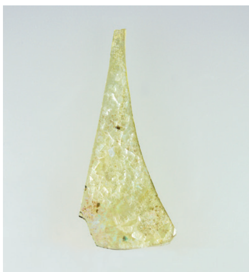
Abb. 2 Schollenbildung und -ablösung im Überzug und den darunterliegenden Korrosionslamellen, M 1:1 (Foto: Fachhochschule Erfurt/L.-K. Renker).
