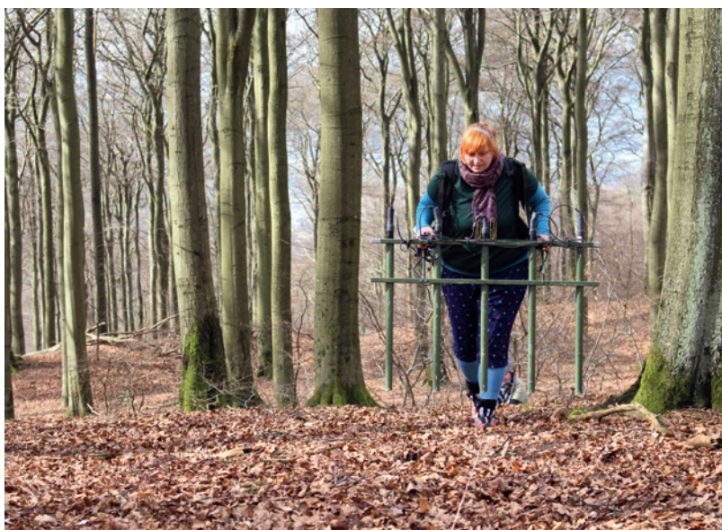
Abb. 3 Alte Burg bei Netphen: Magnetometermessung mit einem Fluxgate-Magnetometer mit fünf Sonden (Foto: LWL-Archäologie für Westfalen/M. Zeiler).
