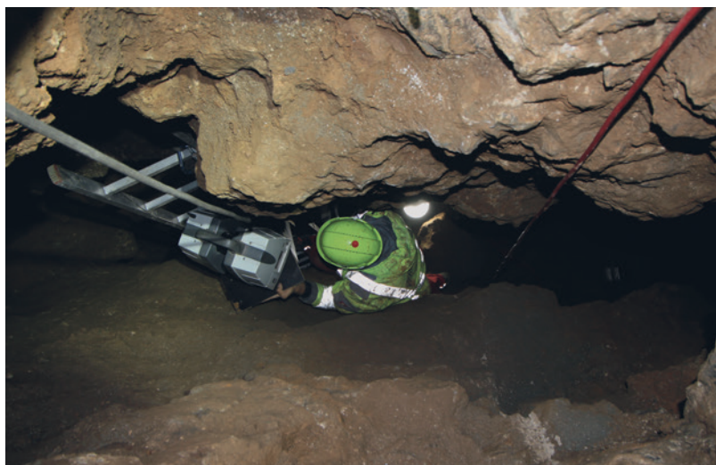
Abb. 1 Blick von oben in die Engstelle des Tiefbaus. Der Laserscanner ist an einer Leiter montiert (Foto: LWL-Archäologie für Westfalen/M. Zeiler).
