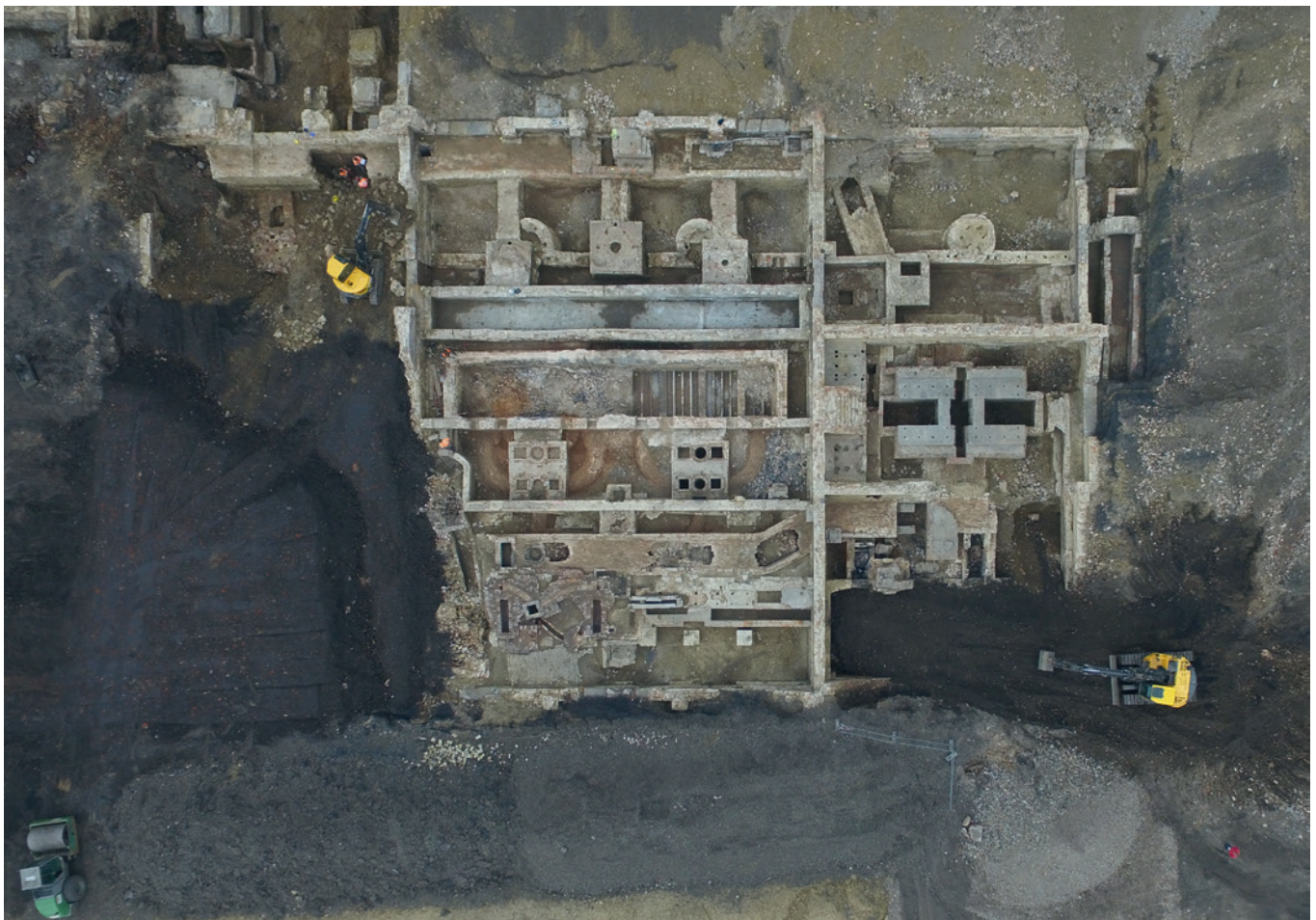
Abb. 4 Alte Bessemerie mit Befunden des ältesten Bessemerwerks, dem Walzwerk einer Modernisierungsphase sowie den Öfen der Siemens-Martin-Anlage (Orthofoto: ABS Archäologische Baugrunderkundung GmbH/J. H. Höller, I. Luther, F. Kempken).
