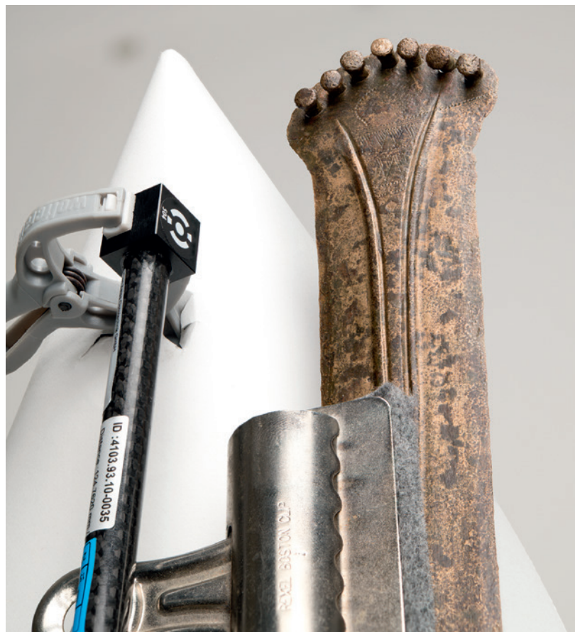
Abb. 3 Die sinnvolle Positionierung vor dem Scan ist vor allem bei Funden mit beweglichen Teilen wichtig. Aufnahmesituation des Bronzedolches aus Petershagen-Hävern mit kalibriertem Maßstab (Foto: LWL-Archäologie für Westfalen/F. Westphal).
