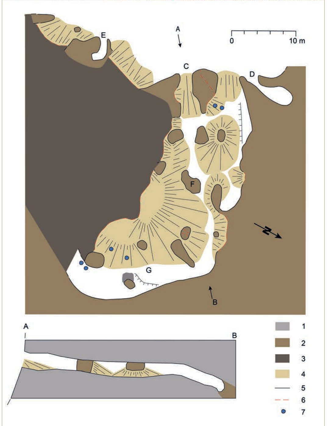
Abb. 2 Grube Reinhold: Gespiegelte Ansicht der Grubenöffnungen (oben), Grundriss (Mitte) und Querschnitt (unten). C–E: durch den rezenten Steinbruchbetrieb entstandene horizontale Zugänge in den Altbergbau; F: Pfeiler rechts auf Abb. 4 ; G: Position der Person auf Abb. 3 ; 1: unverritztes taubes Gestein; 2: Erzvorkommen; 3: vermutete Verbruchzone ausgeerzten Altbergbaus; 4: Verbruchhalden; 5: Konturen der älteren Altbergbauphase; 6: Konturen infolge von Verbrüchen oder Aktivitäten der jüngeren Altbergbauphase; 7: Stempel (Grafik: LWL-Archäologie für Westfalen/M. Zeiler).
