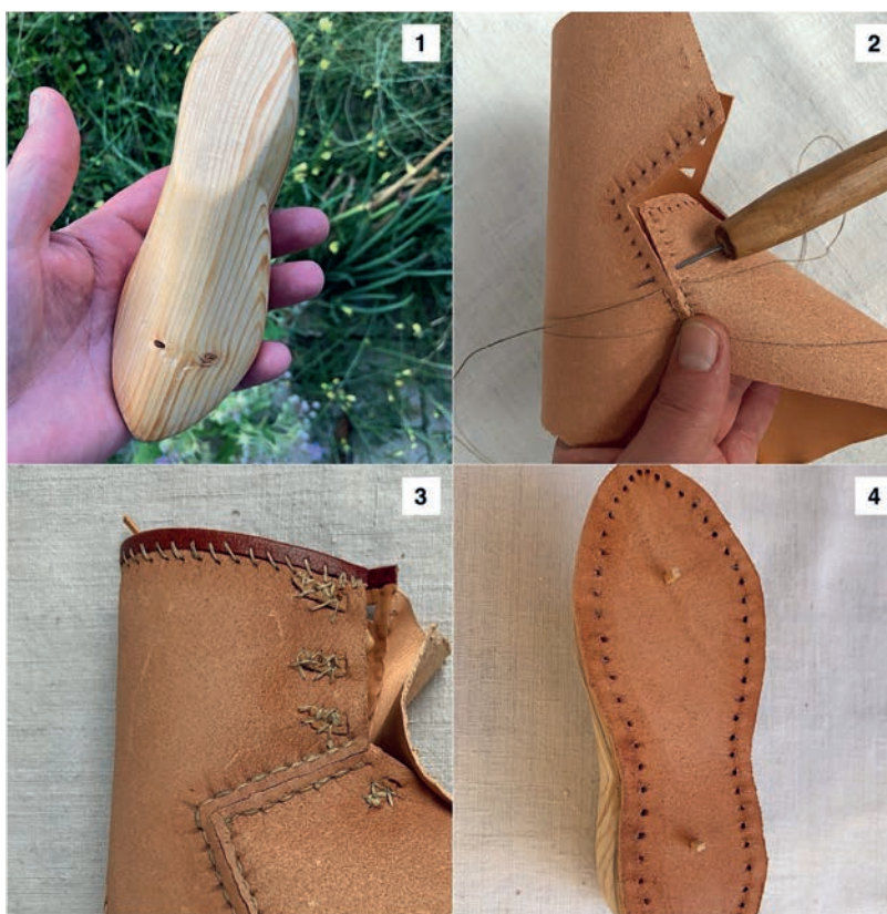
Abb. 3 1: Leisten; 2: Schaftnaht; 3: fertiger Schaft vor dem Wenden; 4: mit Holznägeln befestigte Laufsohle (Fotos: Res Rarae/M. Moser).
