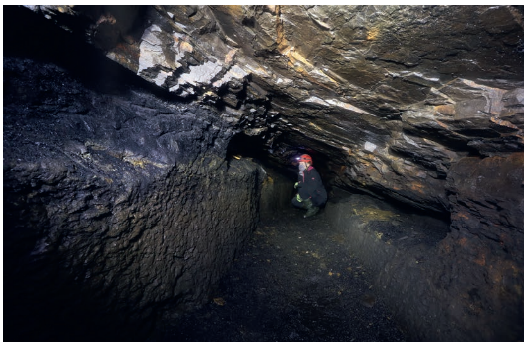
Abb. 5 Blick von Nordost in Strecke 2 mit dem im hinteren Teil hereingewonnenen Flöz sowie deutlichen senkrechten Schrämpspuren im Liegenden (Foto: LWL-Archäologie für Westfalen/T. Poggel).
