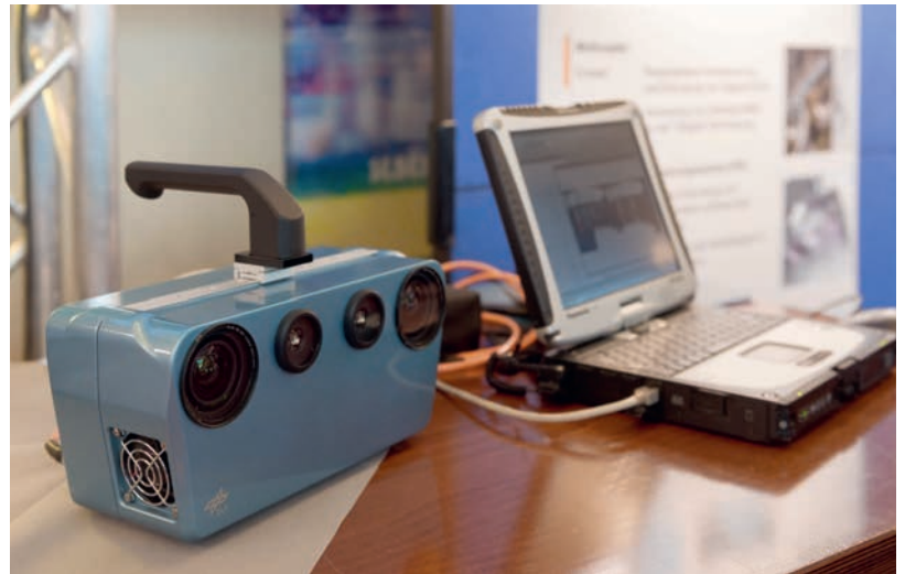
Abb. 1 Integrated Positioning System (IPS) der RAG zur mobilen 3-D-Vermessung untertägiger Hohlräume (Foto: RAG AG/A. Schlienkamp).
