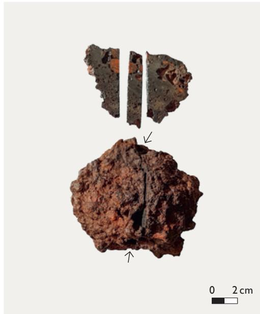
**Abb. 4 (rechts)** Fund-Nr. 1908. Luppe mit Schnittbild, der Schnitt durch die Luppe wurde an der durch Pfeile markierten Linie vorgenommen (Foto: Labor für Archäometallurgie/B. Asmus).
