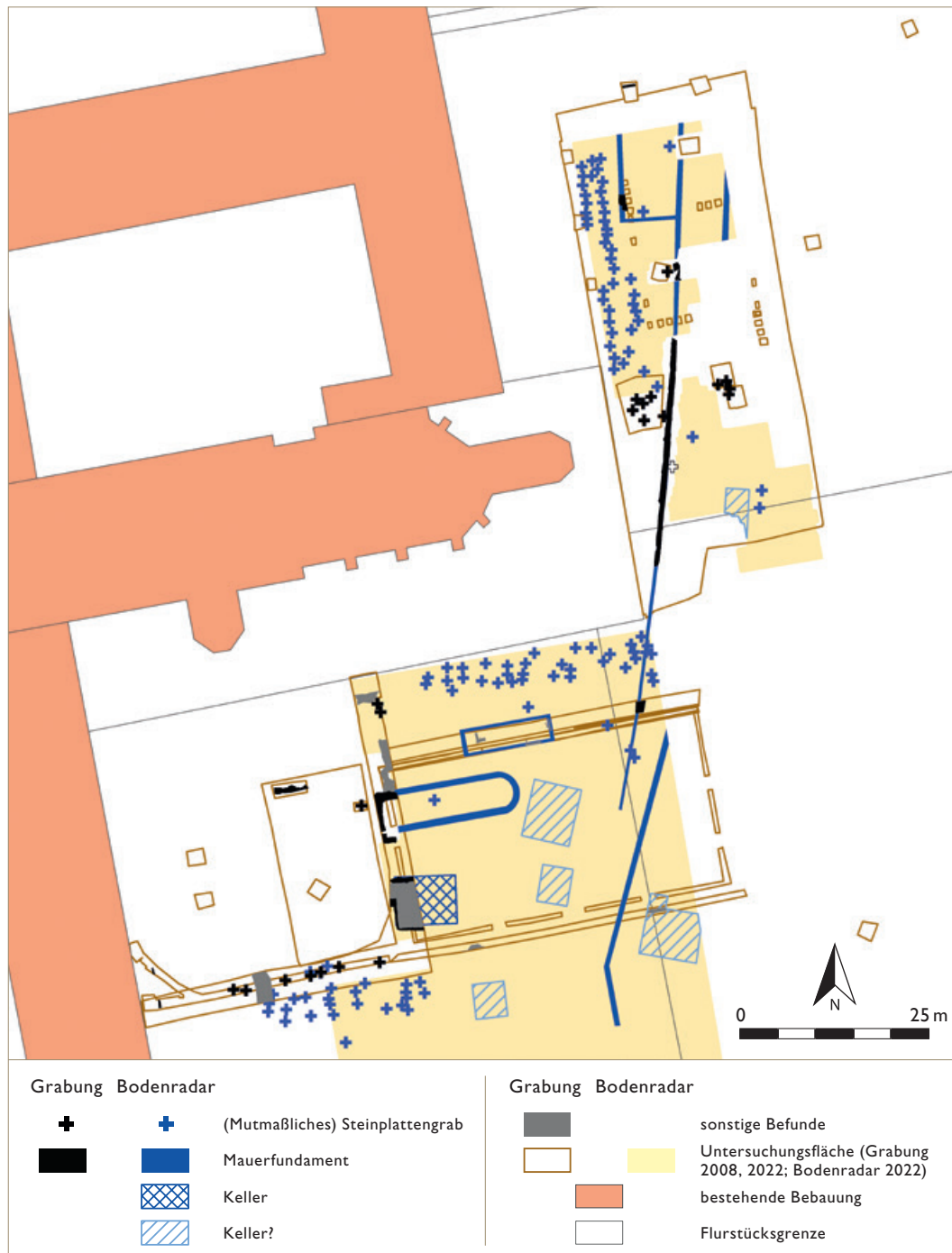
Abb. 1 Kombiniertes Plan der Baubegleitung und der Bodenradarmessung (Kartengrundlage: Land NRW [2023] – Lizenz dl-de/zero-2-0); Radarmessung: LWL-Archäologie für Westfalen/J. Coolen).
