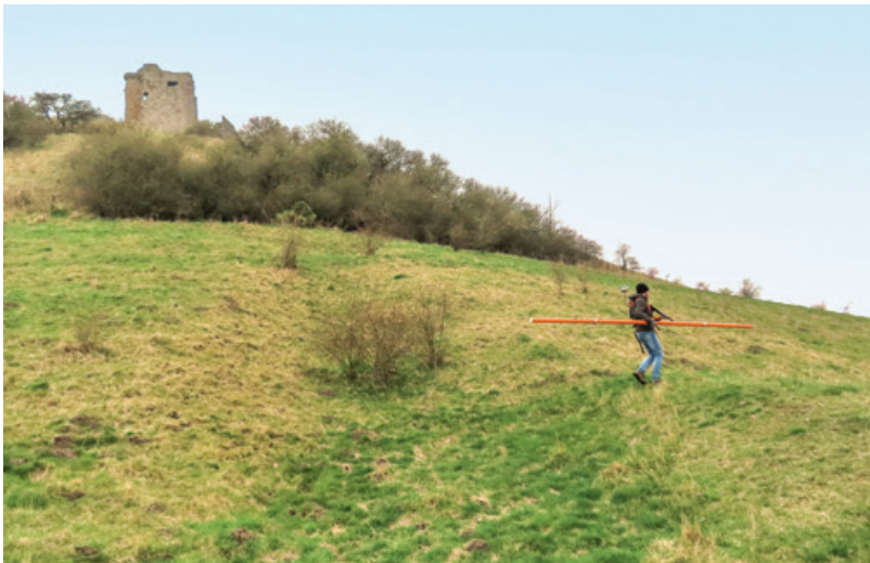
Abb. 3 Seismik-Messungen mittels Hammerschlag am Desenberg. Die Arbeit am Steilhang stellte eine nicht unerhebliche Herausforderung dar (Foto: Christian-Albrechts-Universität zu Kiel/N. Wolpert).
