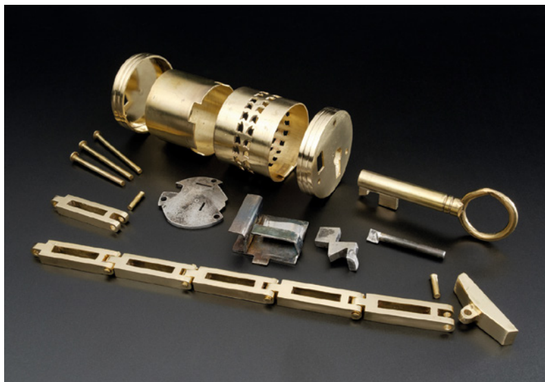
Abb. 5 Durch den in Messing und Stahl im Maßstab 4:1 erstellten Nachbau ließ sich die erstaunliche handwerkliche Leistung bei der Anfertigung des winzigen Dosenschlosses annähernd nachvollziehen (Foto: LWL-Archäologie für Westfalen/S. Brentführer).
