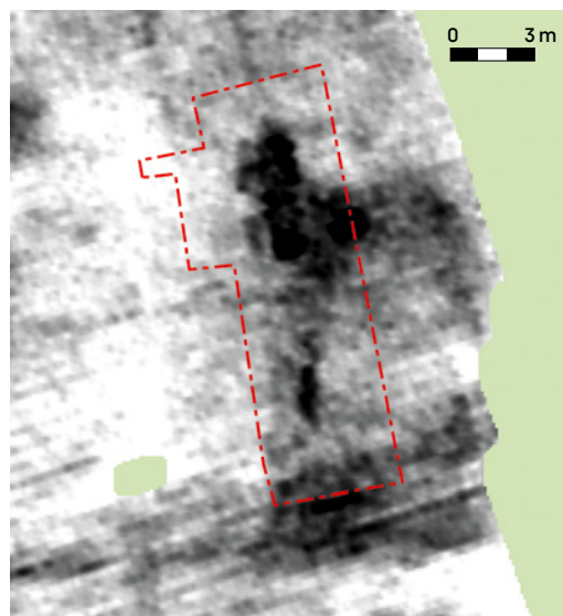
Abb. 3 Stark reflektierende Objekte im Bodengradar schienen auf Reste eines rechteckigen Burggebäudes hinzudeuten. Rot umrandeter Bereich: Grabungsfläche (Grafik: LWL-Archäologie für Westfalen/J. Coolen).
