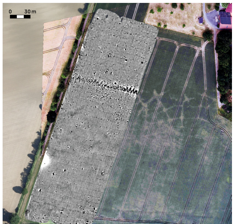
Abb. 2 Ahlen, Schliek (MKZ 4213,240). Im Hintergrund ein rektifiziertes Luftbild von Baoquan Song von Juni 2023, die mutmaßlichen Celtic Fields oder eiszeitlichen Eiskeilpolygone sind als negative (helle) Bewuchsmerkmale zu sehen. Wertebereich des Magnetogramms -2 nT (weiß) bis 2 nT (schwarz) (Kartengrundlage: Land NRW [2023] – Lizenz dl-de/zero-2-0; Grafik: LWL-Archäologie für Westfalen/ J. Coolen).
