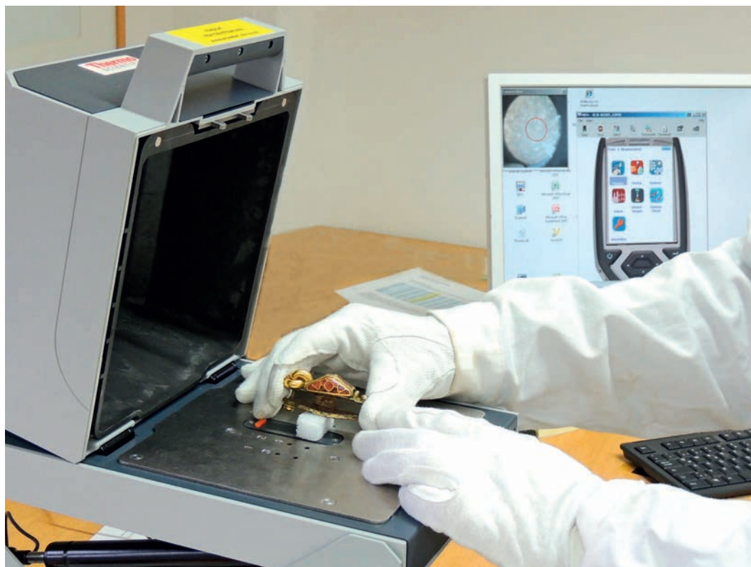
Abb. 1 Das mobile Röntgenfluoreszenzgerät in Einheit mit der transportablen, strahlensicheren Probenkammer, bei der Vorbereitung zur Analyse (Foto: LWL-Archäologie für Westfalen/L. Verweyen).
