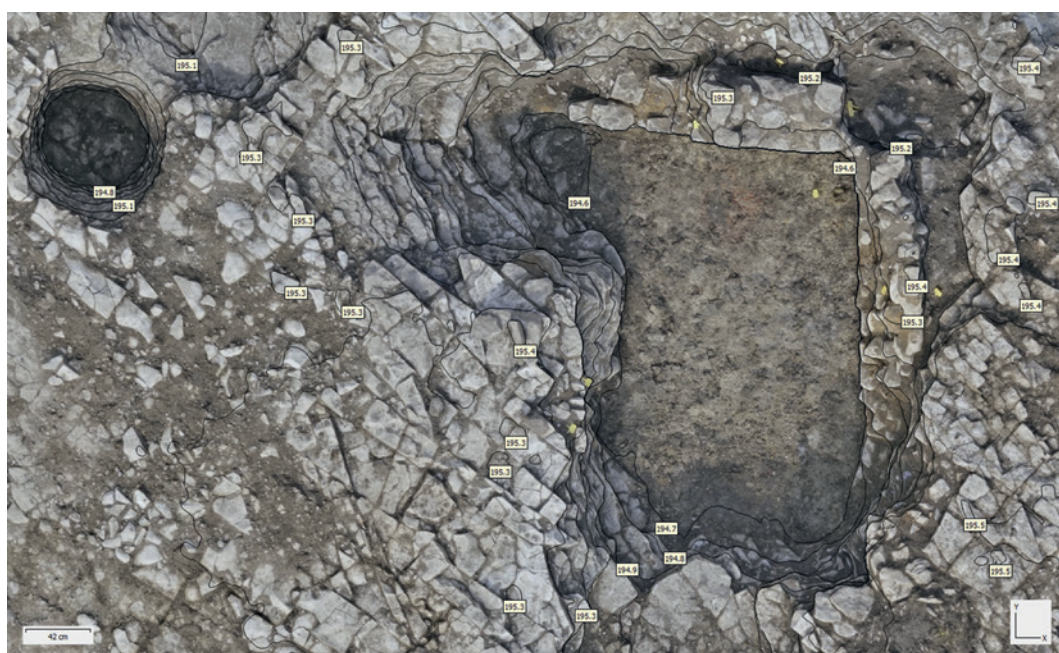
Abb. 2 Ein rechteckiger Keller und der dazugehörige Gebäudegrundriss: Isohypsen aus dem Digitalen Geländemodell und entzerrtes Orthofoto mit Angabe der Höhenlinien (Vermessung und Grafik: Denkmal 3D/C. Melisch, S. Kehlenbrink).
