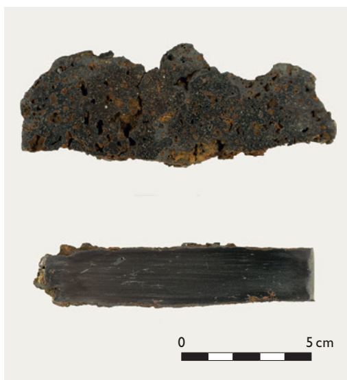
Abb. 2 Angeschliffene Luppenprobe (oben) mit zahlreichen Hohlräumen, Schlackeninklusio-nen und -anhaftungen sowie Stangenprobe (unten) mit eingeregelten Schlacken-einschlüssen (Foto: Deutsches Bergbau-Museum Bochum/D. Demant).
