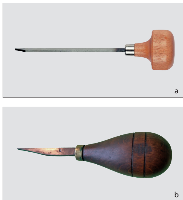
Abb. 9 Moderne Grabstichel für diverse Materialien (a) bzw. für Metall (b). – (a Grafik H. Falk; b Foto Angela Pfahl, Schwäbisch Gmünd, unter Verwendung eines Stichels von Hermann Pfahl [1922-2014]). – b L. 10,5 cm.
