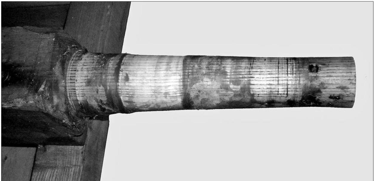
**Abb. 13** Unbeschadeter Zustand eines der gefetteten Achsschenkel am nachgebauten keltischen Streitwagen nach einer Fahrt von ca. 80 km über den Thüringer Wald. – (Foto A. Bräunling).
