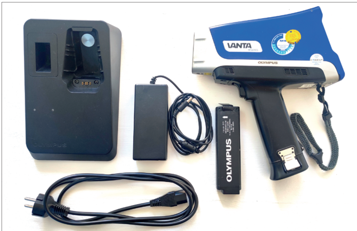
Abb. 2 Das Vanta-M-Spektrometer der Firma Olympus mit der wichtigsten Ausstattung (Netzteil, USB-Kabel, Ladestation mit Teststand). – (Foto M. Helfert)
