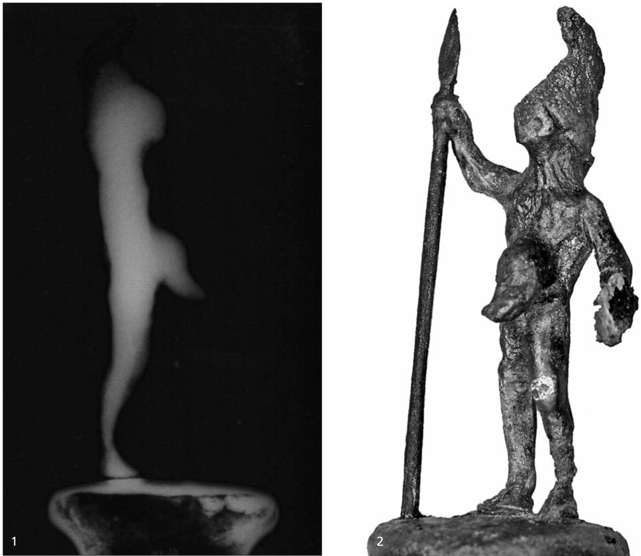
Abb. 9 Schwarzenbach »Spätzrech« (Lkr. St. Wendel). Röntgenaufnahme (1) und Detailansicht (2) der Marsstatuette mit Gussfehler. – (1 Röntgenfoto S. Patscher, RGZM; 2 Foto D. Burger).
