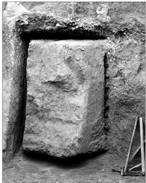
Abb. 1 Der »Experimentblock« kurz vor dem Brechen: An Decke, Boden und an einer Seite ist der Quader durch Schrote vom anstehenden Gestein gelöst. An der anderen Seite sind sieben Keiltaschen eingeschlagen und mit Eisenkeilen bestückt. – (Foto Forschungsbereich Vulkanologie, Archäologie und Technikgeschichte [VAT]).
