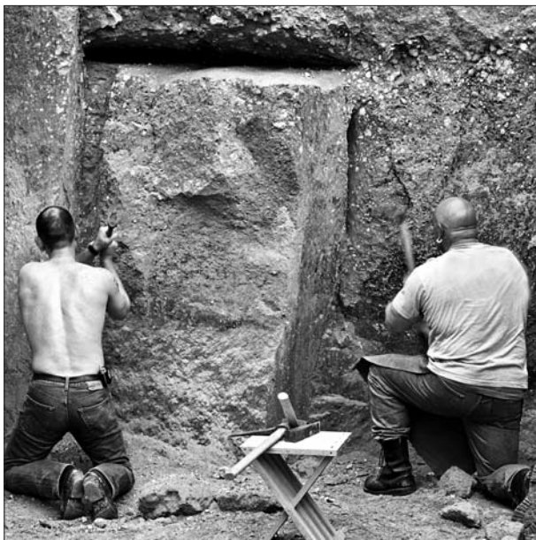
Abb. 15 Schritt 2 des Experiments: das Einarbeiten des Seitenschrots und der Keiltaschen. – (Foto VAT).
