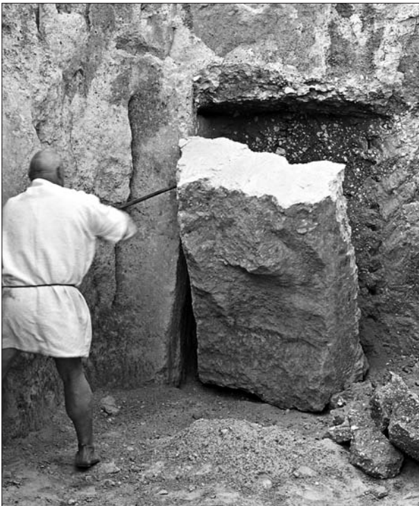
Abb. 18 Schritt 5 des Experiments: Der Stein ist gelöst und wird mithilfe einer Brechstange umgeworfen. – (Foto VAT).
