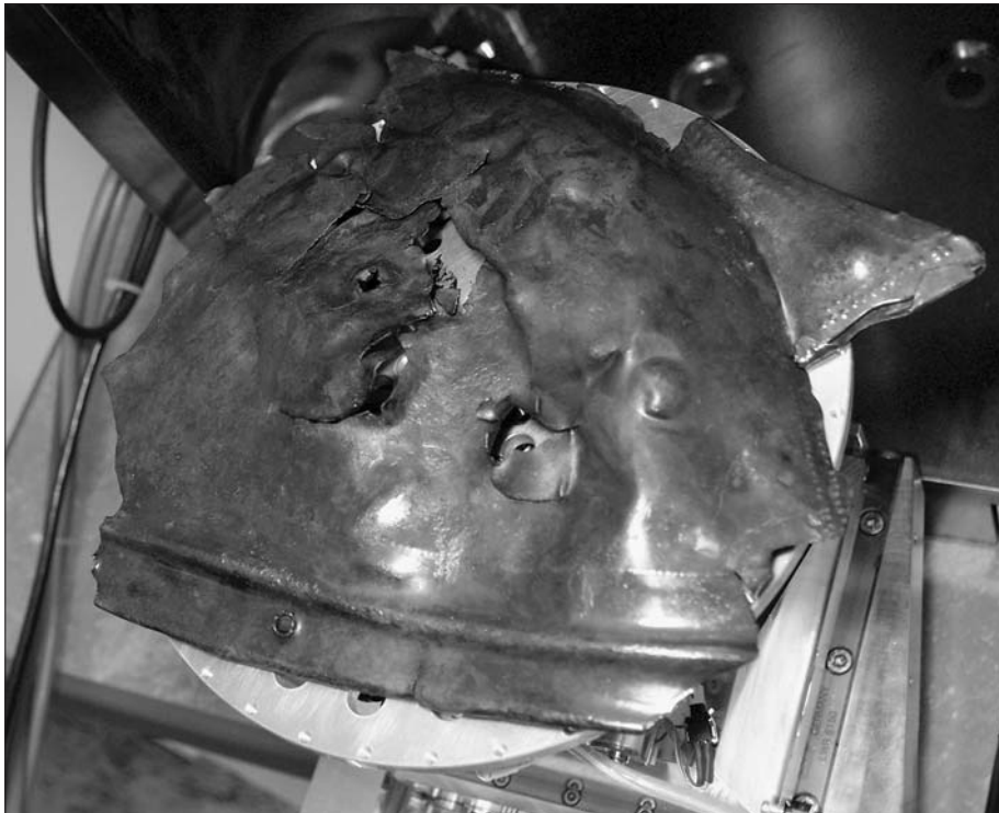
Abb. 7 Die Probenkammer des Rasterelektronenmikroskops (Dm. 40 cm) mit dem Helmfragment aus dem Anlaufstal. Der Fundgegenstand kann so völlig zerstörungsfrei untersucht werden. – (Photo M. Mehofer).
