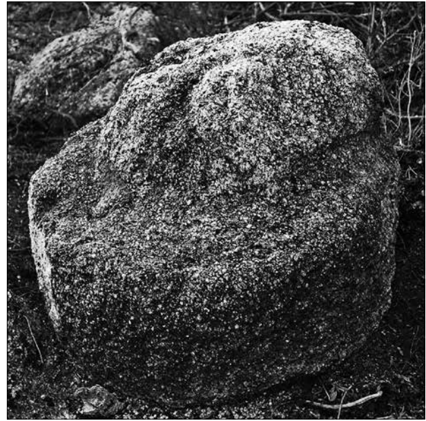
Abb. 14 Steinbruch von Fonte da Ribeira (distr. Vila Real/P). Werkstein mit fertiggestellter Orientierungsfläche und Rundung. Beim Zuarbeiten der Gegenfläche (s. Schlagspuren) zerbrach der Stein und musste wegen eines Stiches verworfen werden. – (Foto R. Wahl-Clerici).
