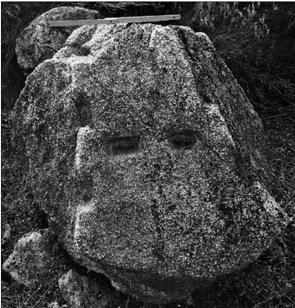
Abb. 6 Steinbruch von Fonte da Ribeira (distr. Vila Real/P). Vorbereitung zur weiteren Teilung eines Blocks, der je seitlich bereits reduziert wurde. – (Foto R. Wahl-Clerici).
