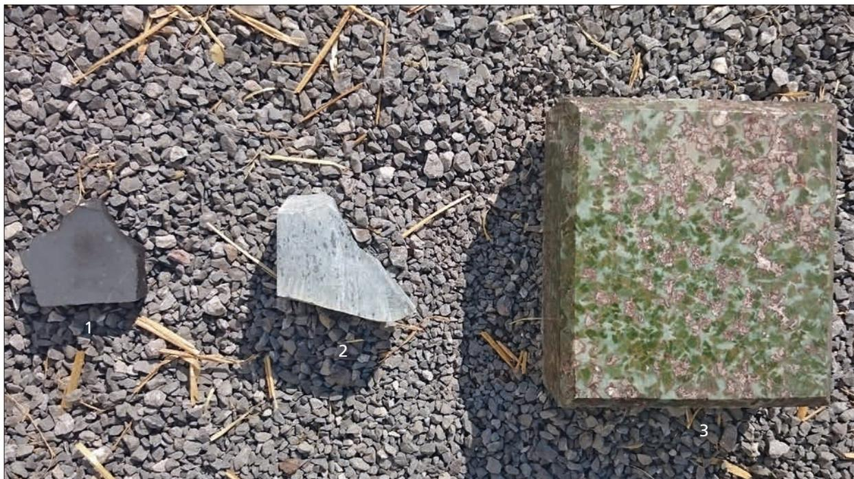
**Abb. 3** Die drei mittels pXRF untersuchten Testgesteine: **1** feinkörniger Basalt. – **2** ungleichkörniger Geisspfad-Serpentinit. – **3** grobkörniger Allalin-Gabbro mit glatt polierter Oberfläche. Der Allalin-Gabbro misst 16 cm × 19 cm. – (Foto Th. Burri).
