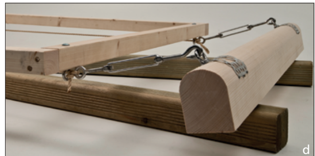
Abb. 11 Nachempfundene Aufhängung der Wagenplattform von Trier mit Zubehör aus dem Baumarkt. a Seitenansicht. – b Unteransicht nach Lösen der Knoten. – c Ansicht bei maximaler Belastung einer Vorderecke. – d Detailansicht mit Verknotung. – (Fotos Th. Zühmer, Rheinisches Landesmuseum Trier).
