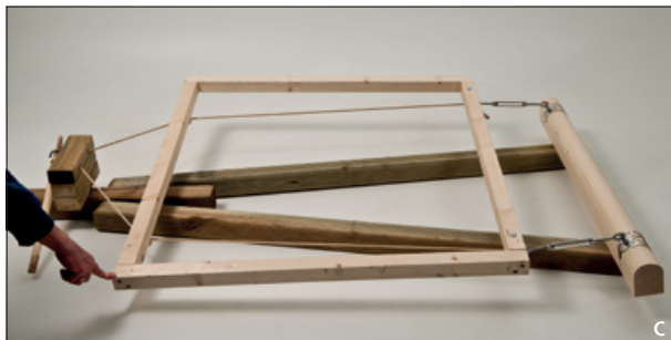
Abb. 11 Nachempfundene Aufhängung der Wagenplattform von Trier mit Zubehör aus dem Baumarkt. a Seitenansicht. – b Unteransicht nach Lösen der Knoten. – c Ansicht bei maximaler Belastung einer Vorderecke. – d Detailansicht mit Verknotung. – (Fotos Th. Zühmer, Rheinisches Landesmuseum Trier).
