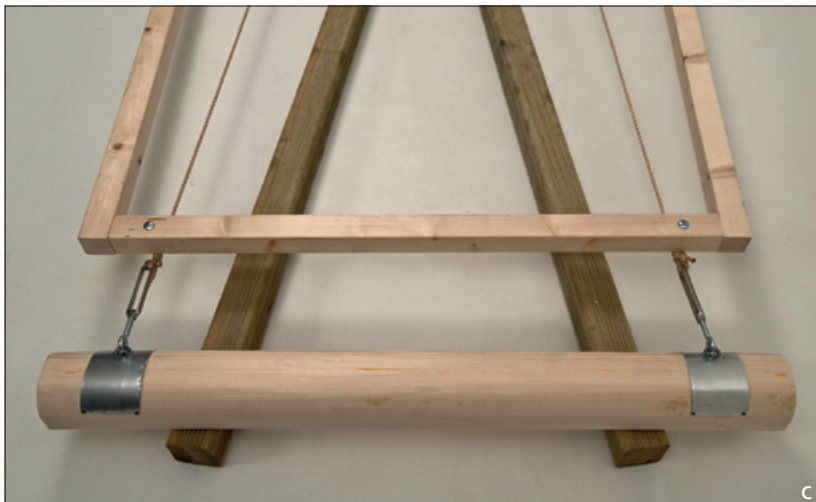
Abb. 12 Nachempfundene Aufhängung der Wagenplattformen von Trier und Bescheid, Hügel 6, mit Zubehör aus dem Baumarkt. a modern nachgestellter Beschlagsatz für Trier. – b modern nachgestellter Beschlagsatz für Bescheid. – c Versuchsanordnung Bescheid. – (Fotos Th. Zühmer, Rheinisches Landesmuseum Trier).
